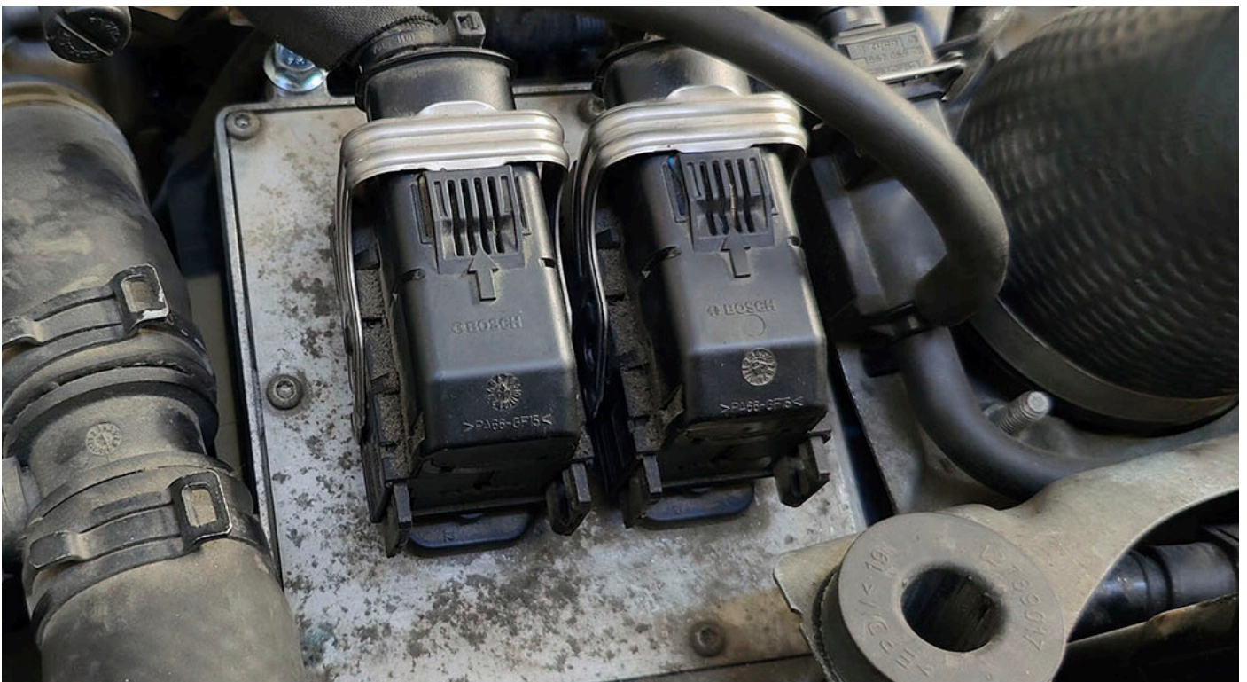
13. Kiinnitä moottorinohjainyksikön liittimet.
